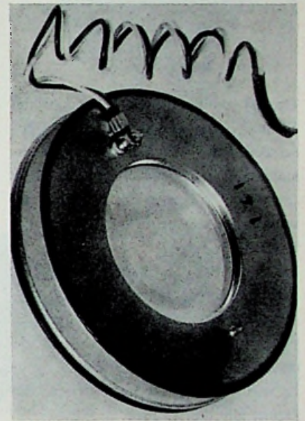
Siemens bestuurbare gelijkrichter voor 700A en 1000 volt proefspanning. Het Si-tablet heeft een diameter van 32.5 mm
